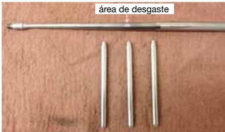
Sin embargo, el mandril Airetool se rompió Después de 345 expansiones, requiriendo 35 minuas de trabajo para extraer el mandril, y los rodillos necesitaron reemplazo.
